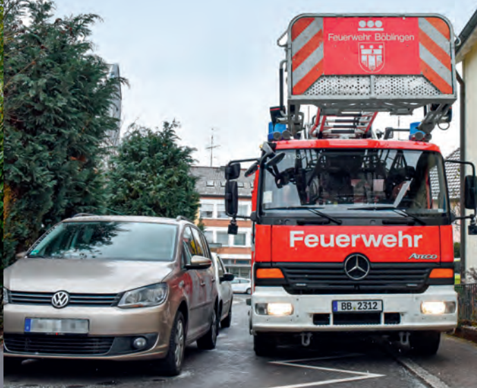
Hier wird die Restfahrbahnbreite nicht eingehalten – der Gehweg gehört nicht dazu. Das Befahren mit großen Fahrzeugen wird erschwert, das Aufstellen der Drehleiter der Feuerwehr sogar eingeschränkt bis unmöglich gemacht.
